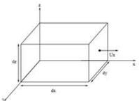
Le même raisonnement peut être fait dans la direction  $y$  et dans la direction  $z$ . Le bilan de flux au travers des faces du volume peut donc s'écrire
