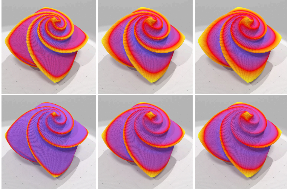
Figure 3.18 Estimateurs différentiels digitaux par intégration sur une surface digitale (OCTAFLLOWER de dimension 256^3 ) avec trois rayons différents : R = 15, 25, 30 . De haut en bas, courbure moyenne, courbure gaussienne.
