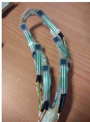
Figure 61 – Disposition de capteurs sur une cuillère de forceps
