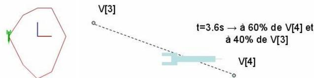
Écrivez le code permettant de **placer un objet sur la trajectoire en fonction du temps** (ne pas considérer l'orientation de l'objet pour l'instant). Il faudrait qu'au *temps*=3.6, l'objet soit entre le point `V[3]` et le point `V[4]` (plus exactement à 60% du point `V[4]` et à  $100-60=40\%$  du point `V[3]`). Oui, c'est une interpolation linéaire !
