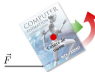
Force appliquée de façon désaxée à l'axe principal. (provoque un déplacement vers la droite ET une rotation)
