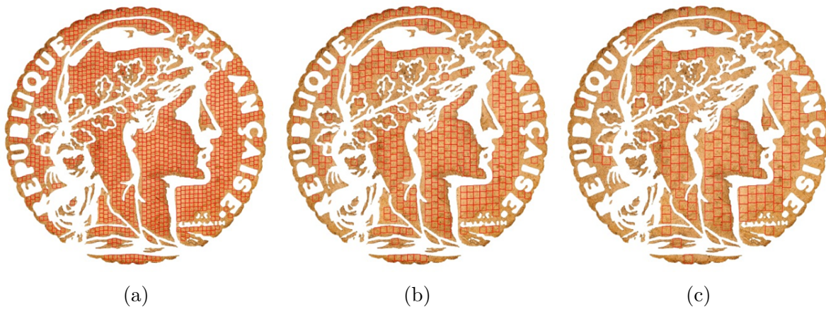
FIGURE 7.11 – Division de la zone d'intérêt en imagettes de différentes tailles fixées : (a) 32 \times 32 pixels ; (b) 48 \times 48 pixels ; (c) 64 \times 64 pixels
