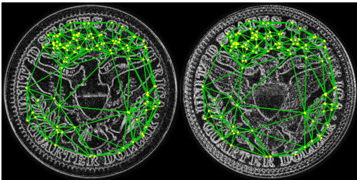
FIGURE 5.11 – Construction de deux graphes quasi-identiques à l’aide des triangulations de Delaunay
