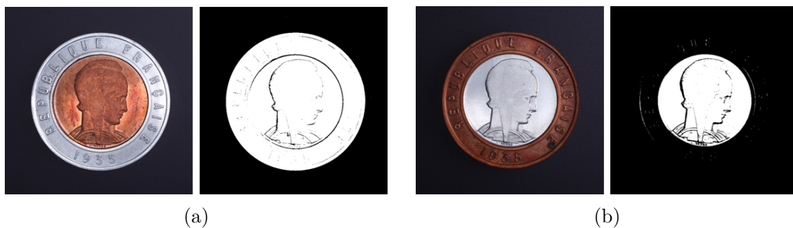
FIGURE 2.5 – Exemples de monnaies bimétalliques segmentées à l'aide de la méthode d'Otsu : (a) monnaie globale avec une intensité différente de l'arrière-plan ; (b) monnaie avec une partie dont l'intensité est proche de l'arrière-plan
