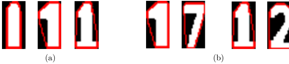
FIGURE 6.9 – Exemples de polices courantes de chiffres binaires et leur enveloppe convexe (en rouge) : (a) chiffres « 1 » avec des « topologies » différentes ; (b) chiffres appartenant aux différentes classes avec des « topologies » similaires
